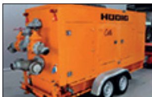
Pompes pour eaux usées
